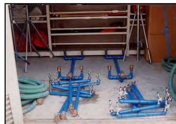
応急給水装置 (配管類)
