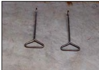
マンホールハンドル
