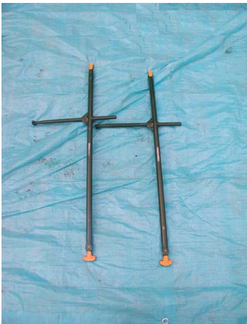
マンホール開閉器.....2本
