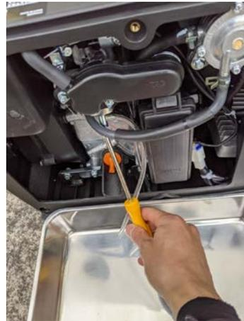
**手順 11** ドレインネジを締め付け、ドレインパイプを元に戻す。
